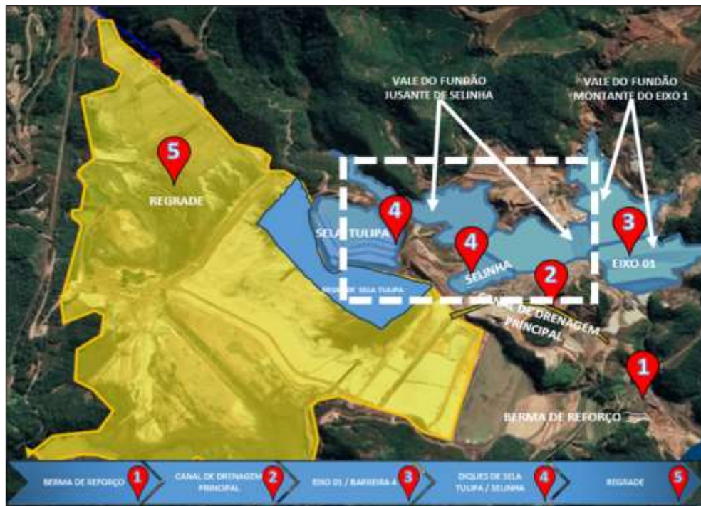
Figura 174: Identificação das Obras do Programa Descaracterização (Selinha)
